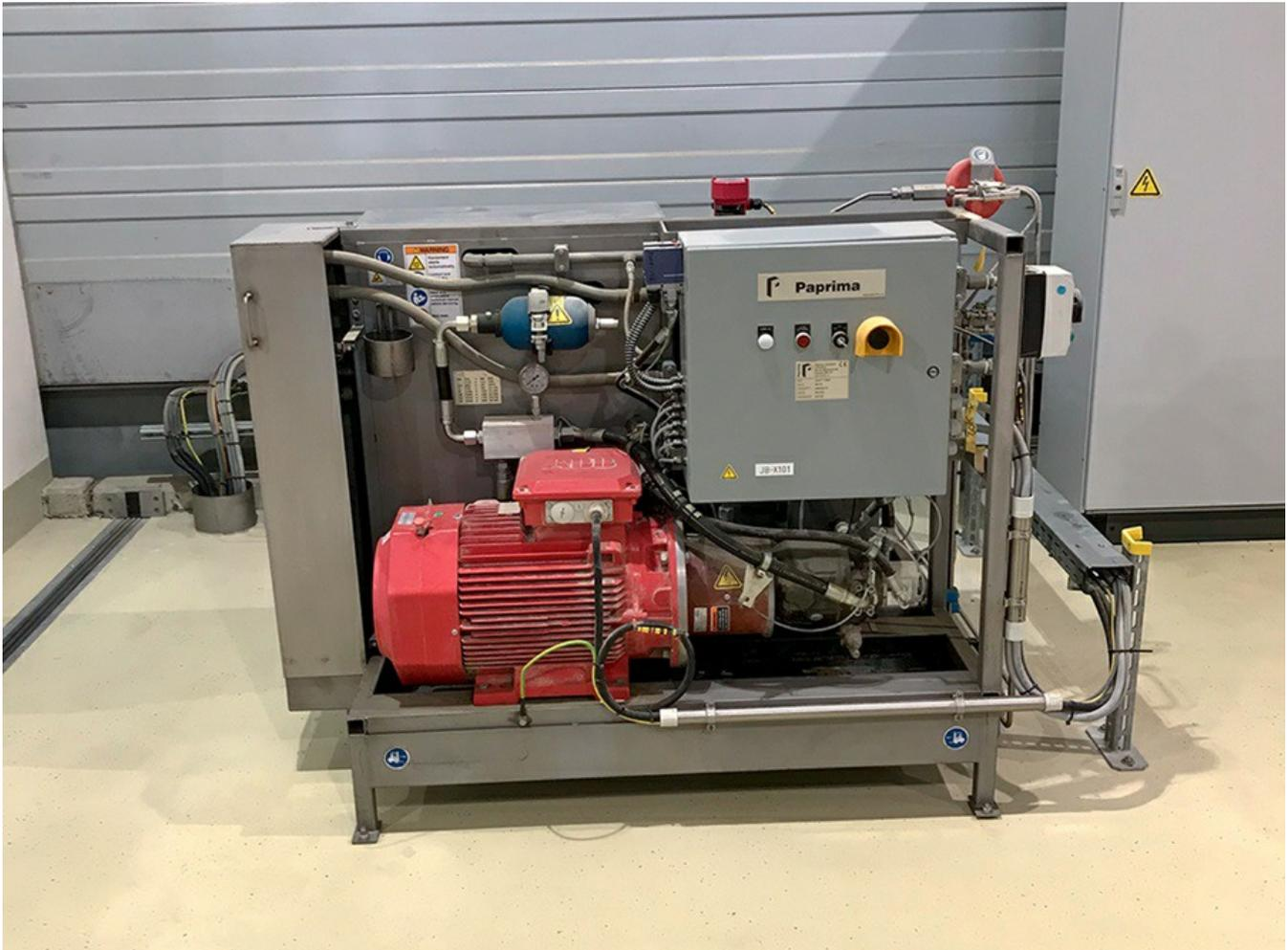
El nivel del aceite lubricante de las bombas de pistón rotativo es esencial para el funcionamiento. Gracias al VEGAPULS 64, ahora dicho nivel se mide de forma fiable.
