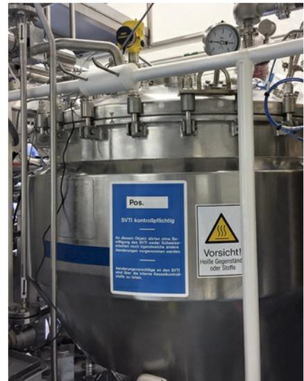
Die extrem kurze Wellenlänge der Radarsensoren VEGAPULS 64 ermöglicht eine hochgenaue Füllstandserfassung während des gesamten Produktionsprozesses.
