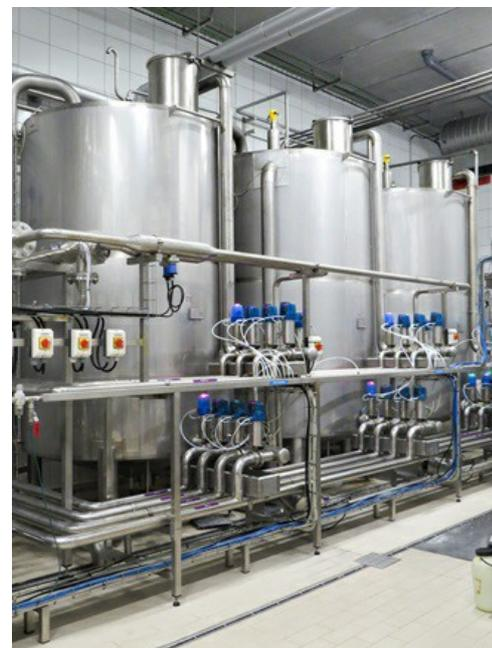
Las plantas CIP son imprescindibles para conservar las condiciones higiénicas de la producción. Los sensores de VEGA miden de forma continua el nivel del producto que se utiliza para limpiar y esterilizar la planta.
