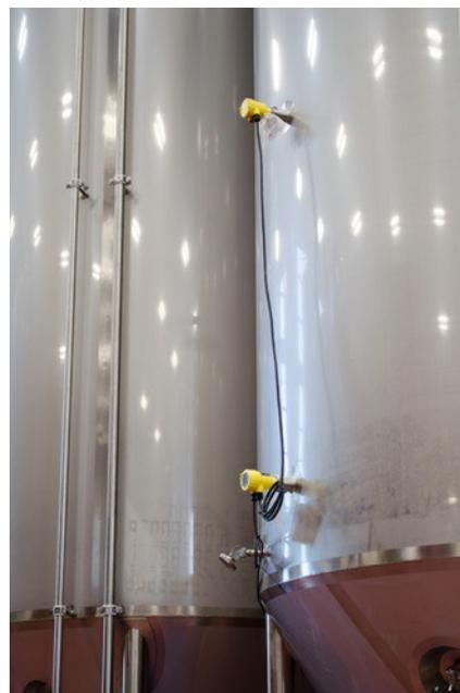
Una visión virtual del depósito: dos sensores VEGABAR combinan un valor de presión diferencial a partir de las presiones de dos puntos distintos.
