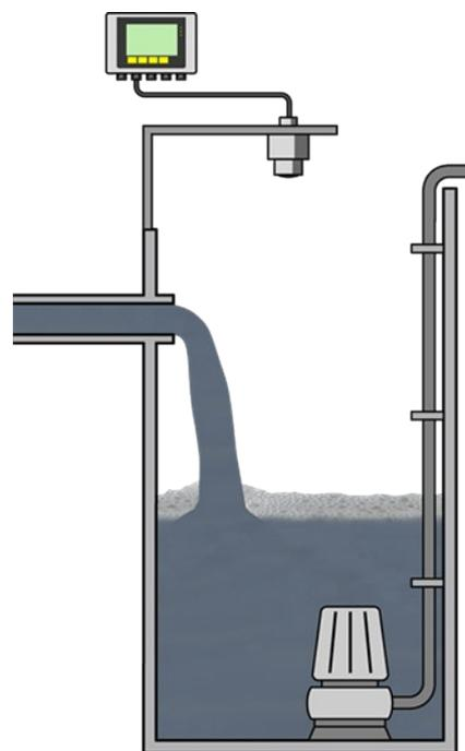
L'excellente focalisation du signal du VEGAPULS permet une détection fiable de la surface du produit, même dans les cuves comportant de nombreuses obstacles internes.
