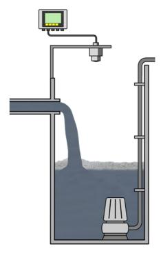
Die sehr gute Signalfokussierung des VEGAPULS ermöglicht auch in Behältern mit vielen Einbauten eine sichere Erfassung der Füllgutoberfläche.
