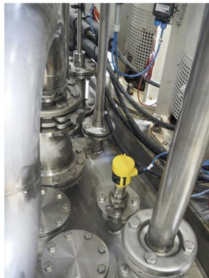
El instrumento de medición de nivel radar VEGAPULS 64 mide el nivel de forma fiable en las plantas de producción.
