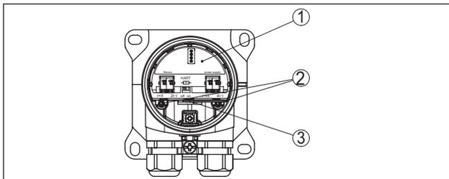
Fig. 2: Desserrez les vis de fixation
