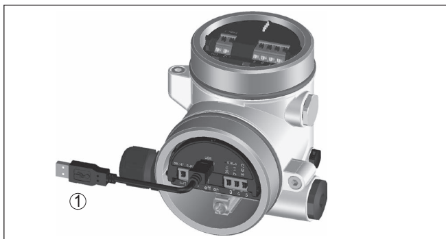
Fig. 22: Conexão do PC ao sistema eletrônico Modbus via USB
