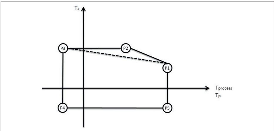
De plus, il faut noter que le graphique défini par les points P1 à P5 a été calculé pour des instruments dont la température process admissible va jusqu'à +195 °C avec une isolation (conductivité thermique de 0,05 W/mK avec 2 cm d'isolant). On a posé deux couches d'isolant de 2 cm d'épaisseur chacune, présentant la conductivité thermique susmentionnée, sur la surface de la cuve.
