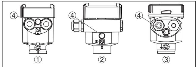
Abb. 1: Position des Filterelementes - Nicht-Ex- und Ex ia-Ausführung
