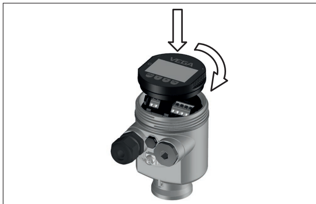
Rys. 5: Wkładanie modułu wyświetlającego i obsługowego do komory układu elektronicznego w obudowie jednokomorowej
