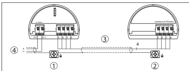
Fig. 4: Exemplo de conexão pressão diferencial eletrônica
