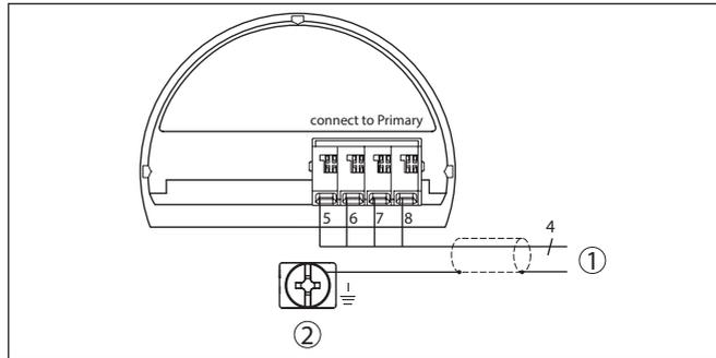
Fig. 3: Esquema de ligações VEGABAR 81 Dispositivo secundário
