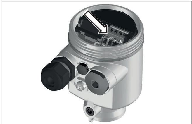
Figura 16: Operazioni di collegamento 5 e 6
