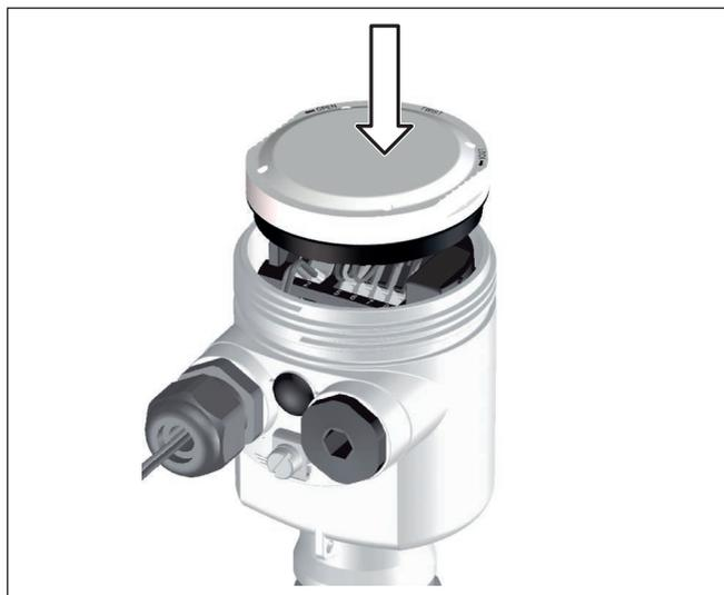
Figura 3: Applicazione del modulo di visualizzazione
