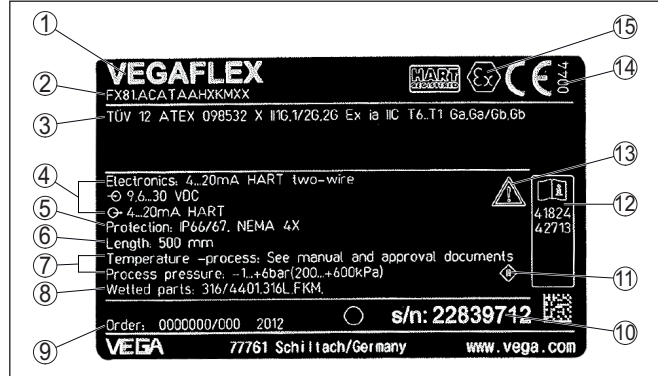
Fig. 1: Estrutura da placa de características (exemplo)
