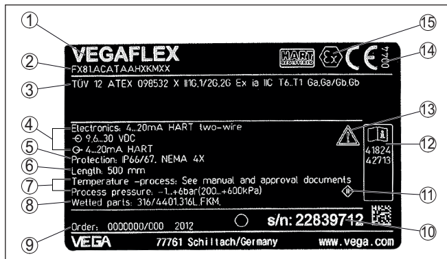
Figura 1: Struttura della targhetta d'identificazione (esempio)
