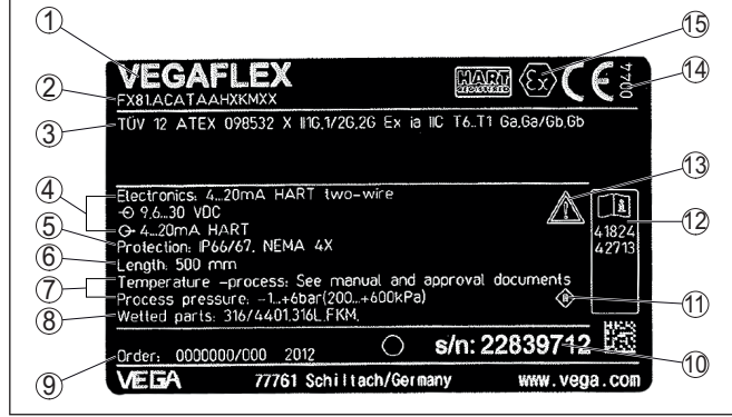
Res. 1: Model etiketinin yapısı (Örnek)
