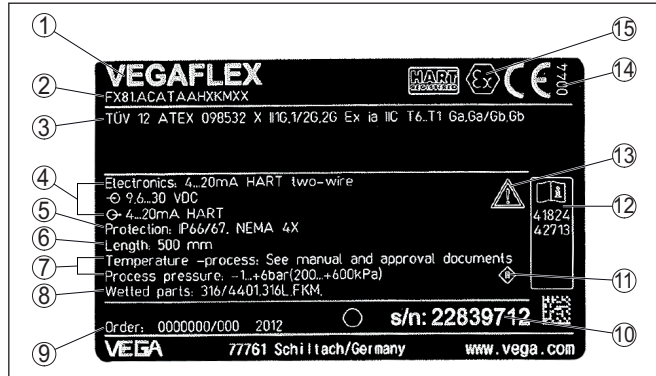
Fig. 1: Estructura de la placa de tipos (ejemplo)
