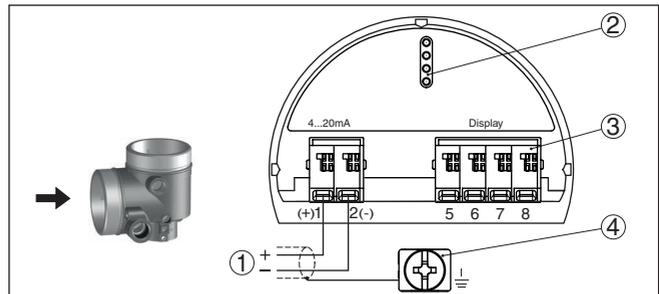
Abb. 8: Anschlussraum - Zweikammergehäuse
