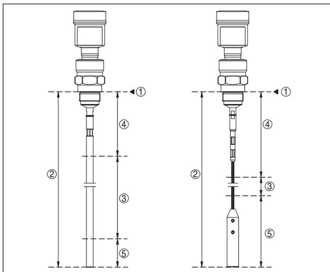
Fig. 12: Faixas de medição - VEGAFLEX 82
