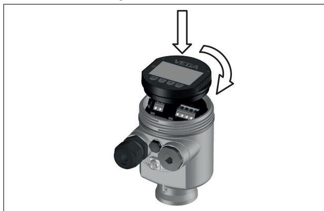
Figura 10: Inserimento del tastierino di taratura con display nel vano dell'elettronica in caso di custodia ad una camera
