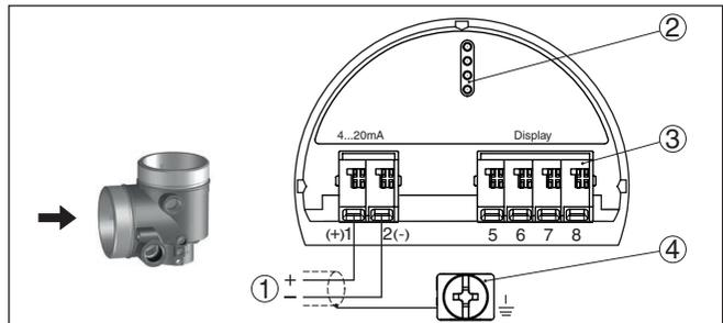
Abb. 9: Anschlussraum - Zweikammergehäuse
