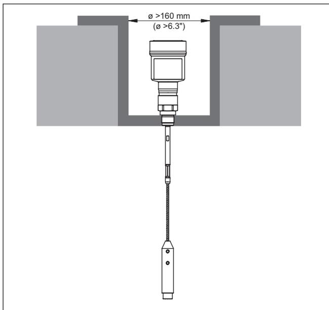
Fig. 4: Montage dans un silo en béton
