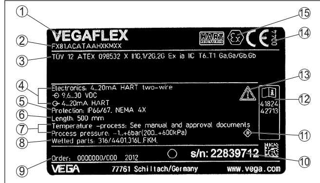
Abb. 1: Aufbau des Typschildes (Beispiel)
