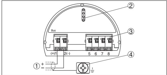
Fig. 9: Compartimiento de conexiones - Carcasa de dos cámaras
