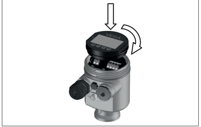
Res. 10: Elektronik bölümünde bir hücreli gövdede gösterge ve ayar modülünün çalıştırılması
