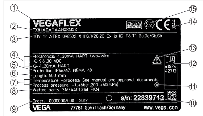
Fig. 1: Estrutura da placa de características (exemplo)
