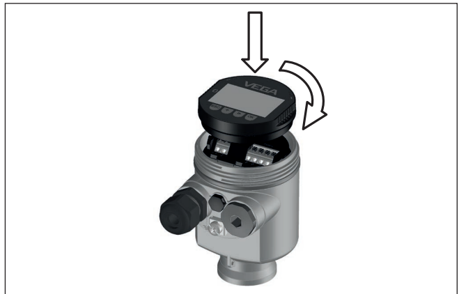
Fig. 10: Empleo del módulo de visualización y configuración en carcasa de una sola cámara el compartimiento de conexión
