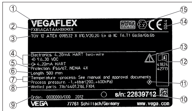
Figura 1: Struttura della targhetta d'identificazione (esempio)
