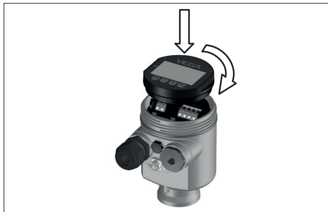
Rys. 12: Wkładanie modułu wyświetlającego i obsługowego do komory układu elektronicznego w obudowie jednokomorowej
