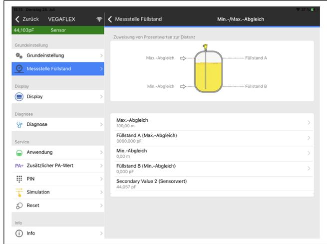
Fig. 16: Ejemplo de una vista de aplicación - puesta en servicio - ajuste del sensor
