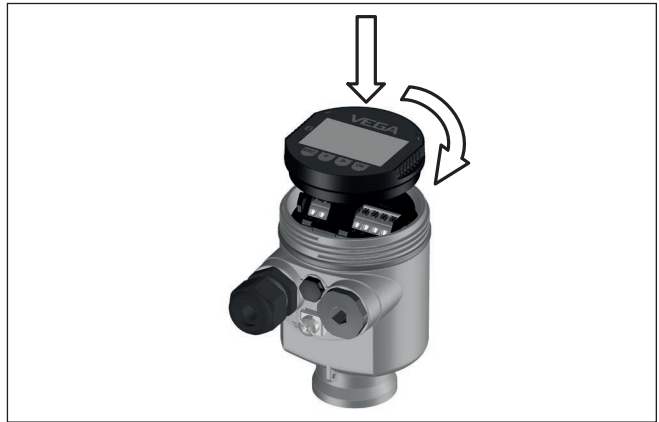
Figura 12: Inserimento del tastierino di taratura con display nel vano dell'elettronica in caso di custodia ad una camera
