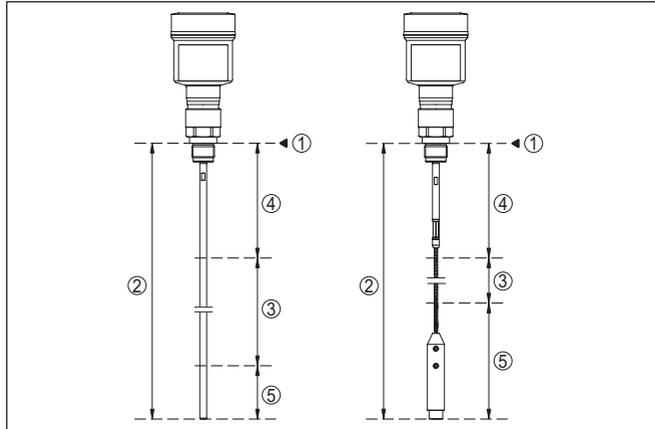
Fig. 11: Plages de mesure - VEGAFLEX 81
