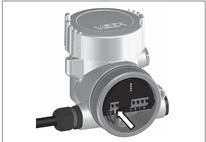
Rys. 6: Czynności przy podłączeniu 5 i 6
