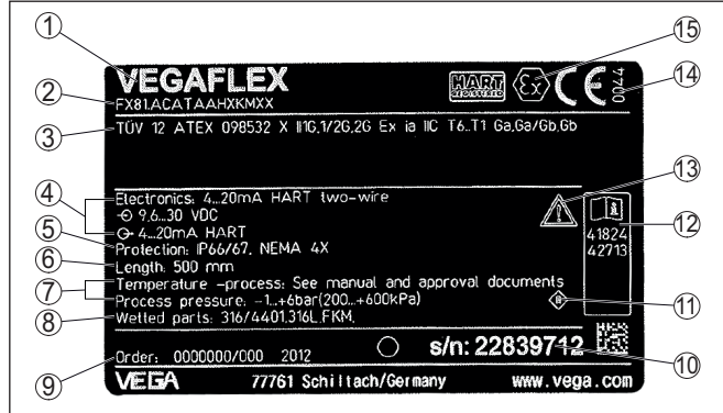
Abb. 1: Aufbau des Typschildes (Beispiel)
