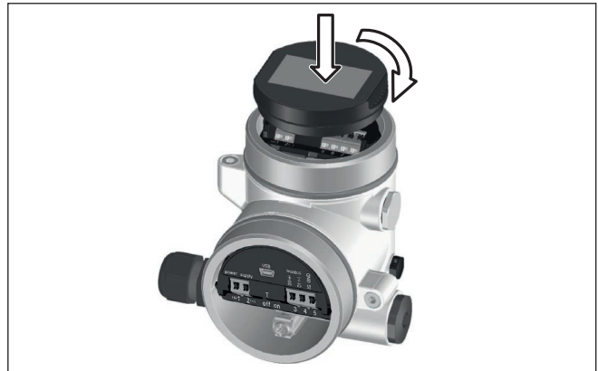
Fig. 7: Inserción del módulo de visualización y configuración
