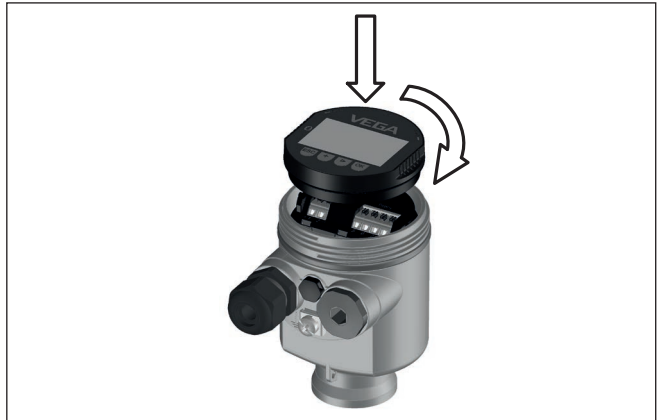
Fig. 6: Empleo del módulo de visualización y configuración en carcasa de una sola cámara el compartimento de conexión
