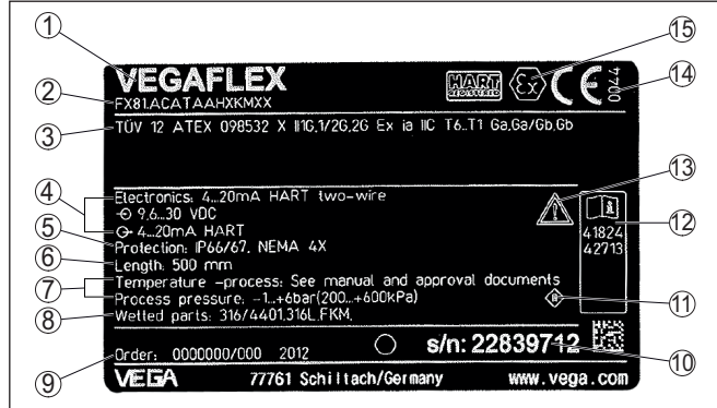
Fig. 1: Opbouw van de typeplaat (voorbeeld)
