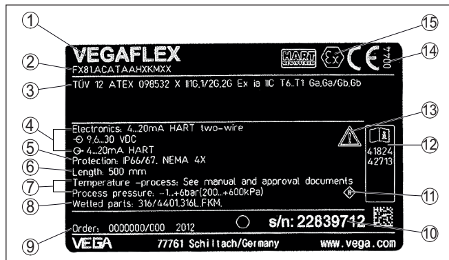
Figura 1: Struttura della targhetta d'identificazione (esempio)
