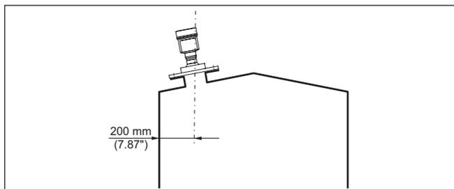
*Fig. 6: Montagem do sensor de radar no teto de reservatório*
