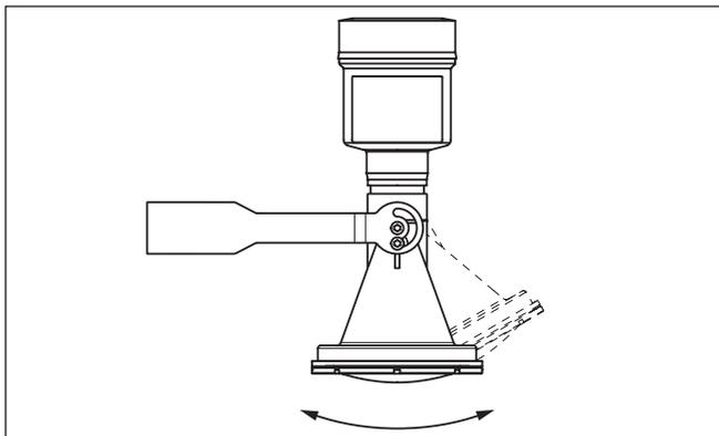
Fig. 3: Ajuste do ângulo de inclinação
