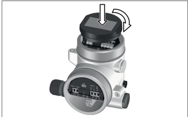
Fig. 11: Colocação do módulo de visualização e configuração
