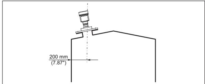
Abb. 6: Montage des Radarsensors an der Behälterdecke
