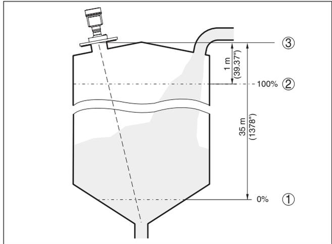
Abb. 12: Parametrierbeispiel Min./Max.-Abgleich
