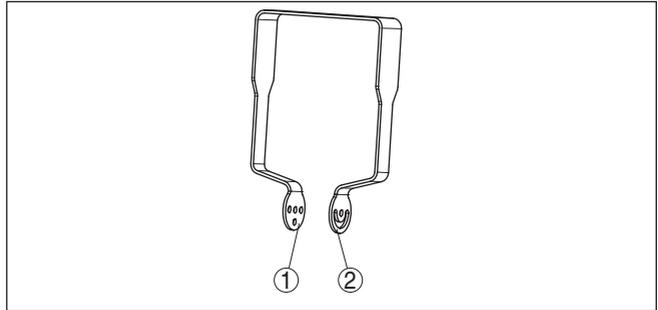
Abb. 2: Montagebügel zum Anschrauben an den Sensor
