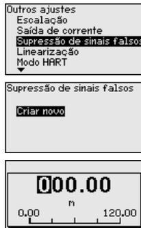
2. Confirmar três vezes com **[OK]** e introduzir a distância real entre o sensor e a superfície do produto.
