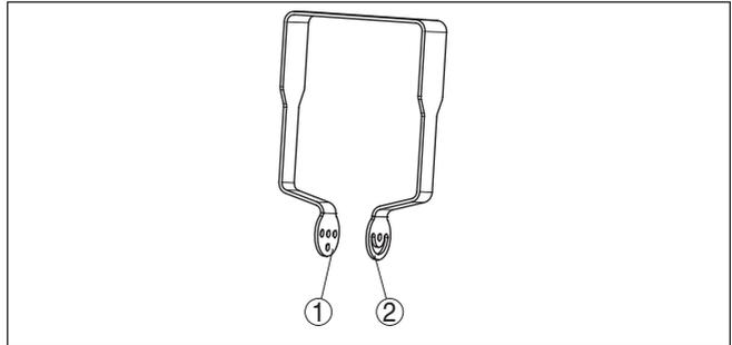
Fig. 2: arco de montagem para aparafusamento no sensor
