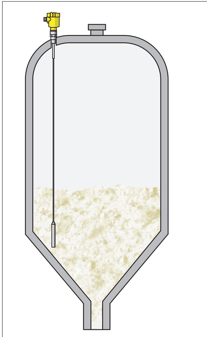
Fig. 20: Medição de nível em granulado de plástico com o VEGAFLEX 82
