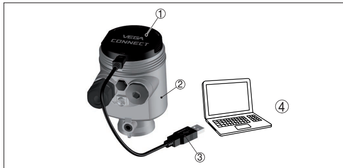
Fig. 36: Aansluiting van de PC via VEGACONNECT en USB
