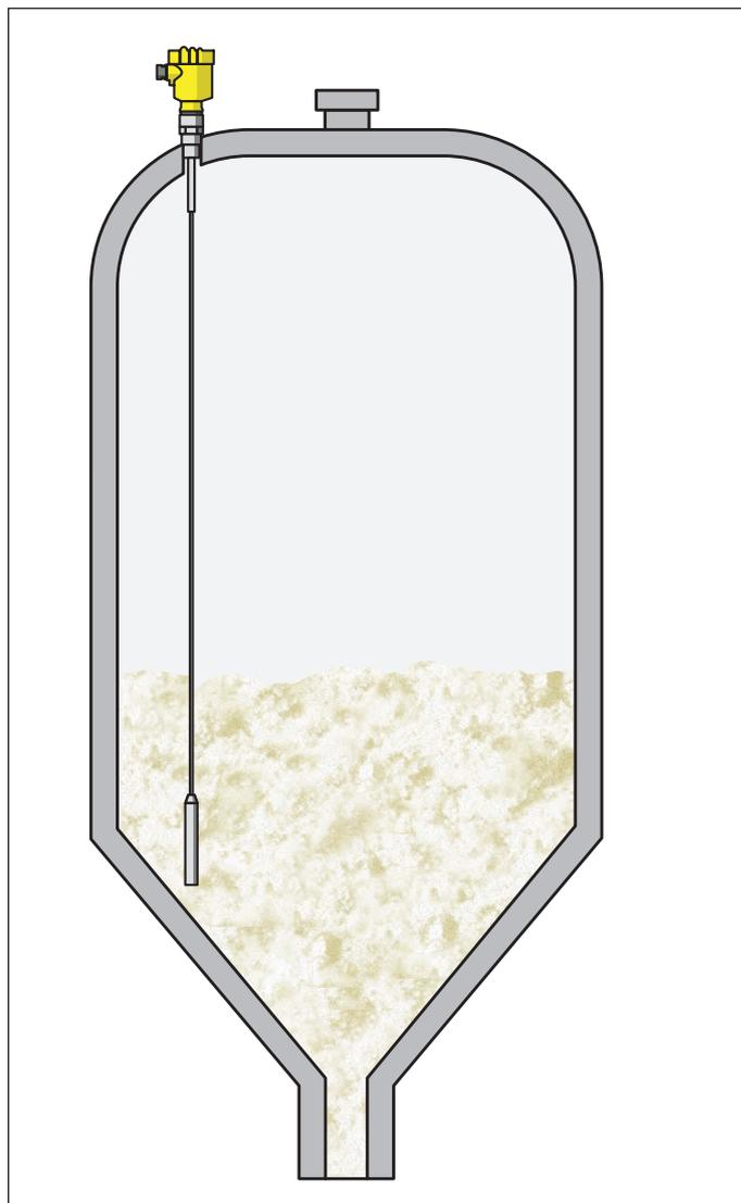
Figura 20: Misura di livello su granulati plastici con VEGAFLEX 82
