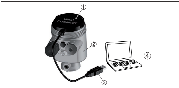
Abb. 36: Anschluss des PCs via VEGACONNECT und USB
