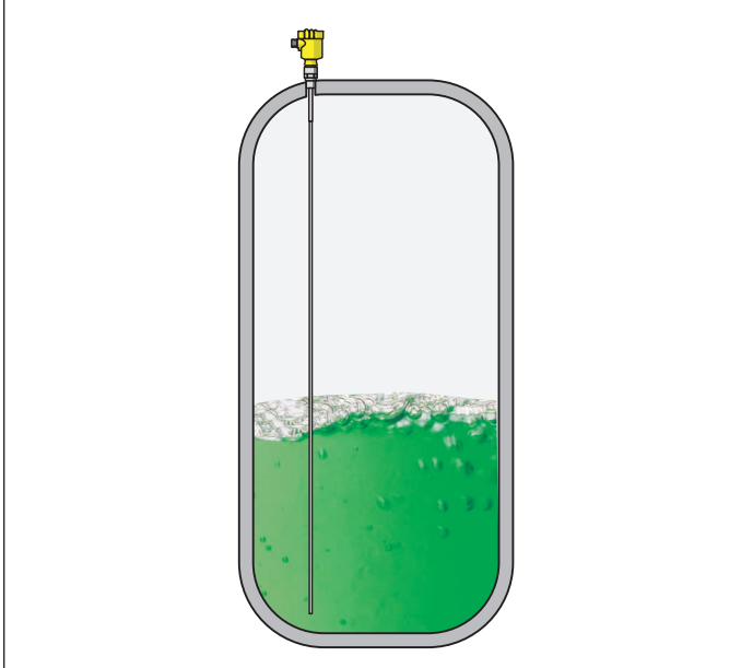
Fig. 28: Medición de nivel en un depósito de almacenaje con VEGAFLEX 81
