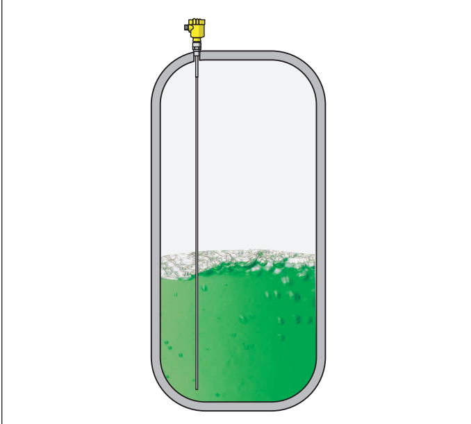
Fig. 28: Niveaumeting in een opslagtank met VEGAFLEX 81
