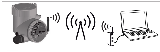
Fig. 50: Overdracht van meetwaarden en parametring op afstand van de sensor via het mobiele netwerk
