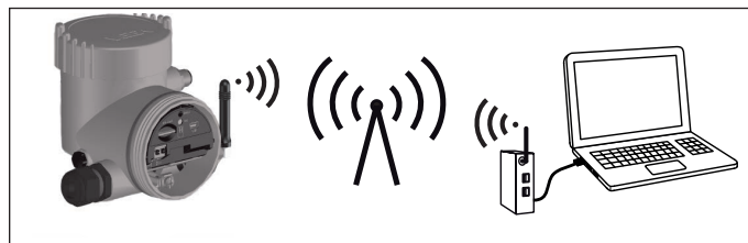
Figura 50: Trasmissione dei valori di misura e parametrizzazione a distanza del sensore attraverso la rete di telefonia mobile
